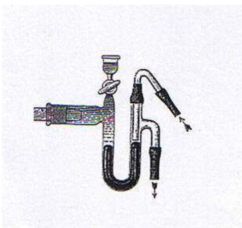
„Der einzige freilich für die Empfindlichkeit des Apparates entscheidende Unterschied besteht darin, dass die Öffnung der Gasflussröhre nicht wie gewöhnlich schief, sondern völlig gerade abgeschnitten ist“ [6, S. 565].
